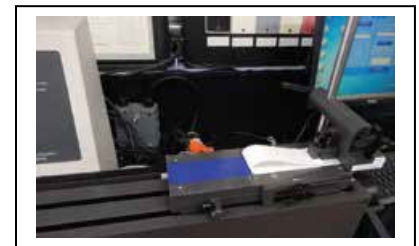
Prueba de liberación del liner a baja velocidad a 180°
